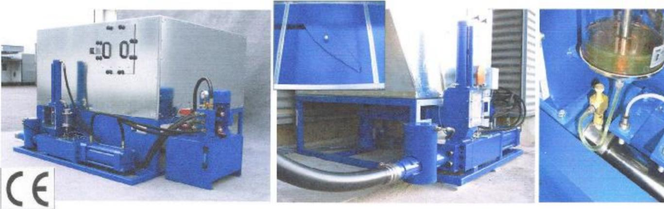
Die Brikkettpresse ist für normales Späne- und Staubmaterial geeignet. Die Pressleistung in kg/h ist materialabhängig, und kann je nach Materialzusammensetzung variieren. Materialfeuchte: zwischen 8 und 20%. Der Spänebehälter sollte bei ECOpressen mit normalem Staub-/ Spänematerial nicht aber 1 m befüllt werden. Kommen Hackschnitzel hinzu, reduziert sich diese Befüllhöhe. Im Zweifelsfalle bitte Angaben beim Hersteller erfragen.
